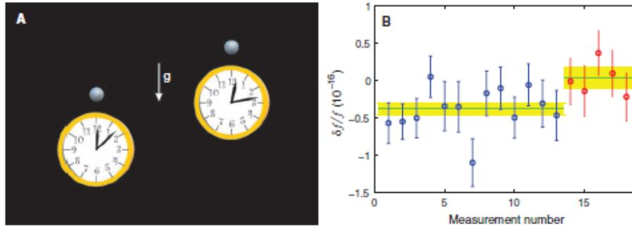
**d.1-** L'expérience a été réalisée avec deux horloges à aluminium telles que décrites précédemment. Les résultats de la variation de hauteur d'une des deux horloges sont visibles sur la courbe. Les points 1 à 13 et 15 à 19 correspondent à deux positions différentes de l'horloge haute. Les droites horizontales représentent la moyenne de ces points et la largeur de la partie grise est une estimation de l'erreur de mesure. De quelle hauteur (même approximative) a été déplacée cette horloge ?
