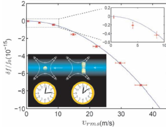
**b-** Cette figure donne la variation de la fréquence observée  $f$  par rapport à  $f_0$  :  $\frac{\delta f}{f_0}$  en fonction de la vitesse mesurée de l'ion de l'horloge :  $v_{rms}$ . Les points expérimentaux et leurs barres d'erreur sont représentés par des points avec des tirets horizontaux et la courbe superposée représente une estimation théorique.
